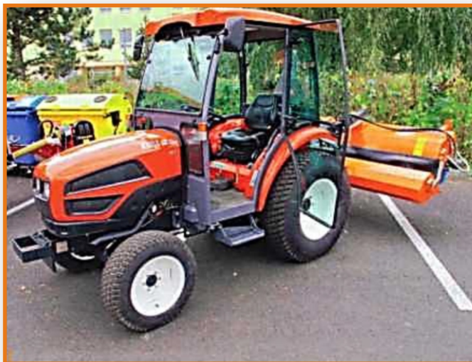
Model Kioti CK 35 byl osazen univerzálním hydraulickým poháněným kartáčem Tichel
