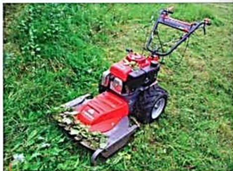
Křovinař Pubert L Senior s motorem Honda (11 k) má vzadu kola, vpředu lyžiny. Mohutný rotační nůž si poradí s nálety až do průměru 5 cm
